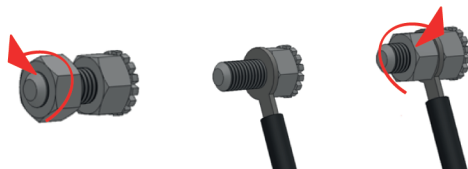
Obrázek č. 7. Připojení přístroje k zařízení pro vyrovnávání potenciálu.
