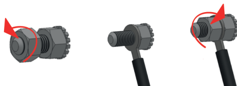
Obrázok 7. Pripojenie zariadenia k vyrovnaniu elektrických potenciálov.
